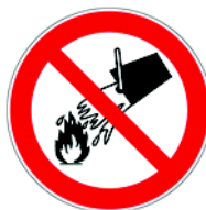
Verboden met water te blussen
